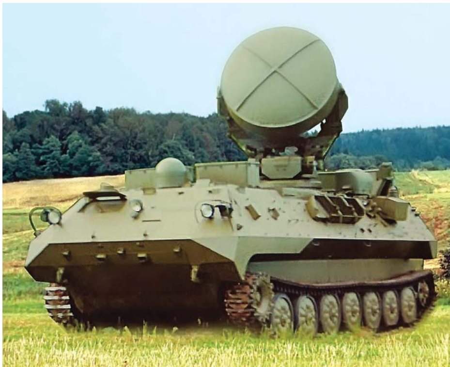
Крајем 1969. Совјети су развили радар АРК-1 намењен за откривање положаја артиљерије
